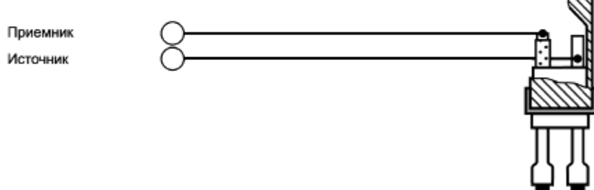
Рисунок 2 - Соединение датчика с измерительным оборудованием
